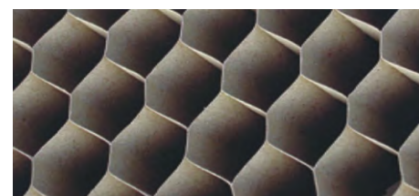
wypełnienie stabilizujące "plaster miodu"
