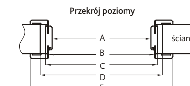
D - wymagana szerokość otworu w murze
