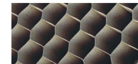
wypełnienie stabilizujące "plaster miodu"
