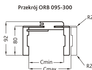
Przekrój pionowy drzwi bezprzylgowych ORB
