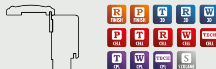
Połączenie opaski z ościeżnicą
