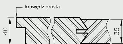
Przekrój poziomy drzwi Elsa
