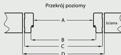
D - wymagana szerokość otworu w murze
