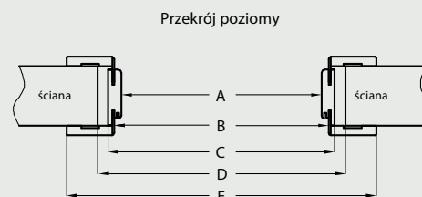
D - wymagana szerokość otworu w murze
