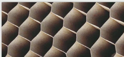
Rys.A. Wkład stabilizujący „plaster miodu”
